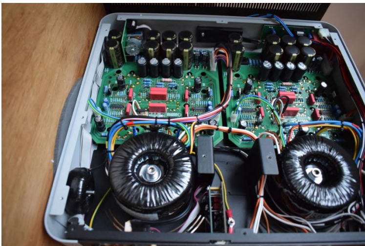
Conception double mono, exemple parfait : le fonctionnement interne de l'OLYPIA (Photo : H. Biermann)
