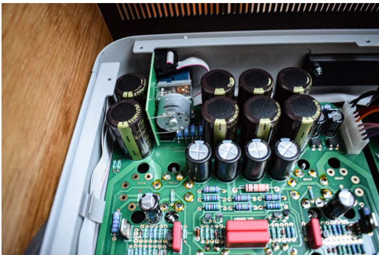
L'image montre le potentiomètre de volume réglable et le filtrage de l'alimentation, composé de huit condensateurs de grande capacité et de quatre de petite capacité par canal (Photo : H. Biermann)
