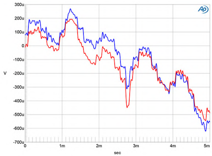
Fig. 6 FEZZ Equinox, forme d'onde d'une sinusoïde de 1 kHz non tramée à -90,31 dBFS, données 16 bits (canal gauche bleu, canal droit rouge)
